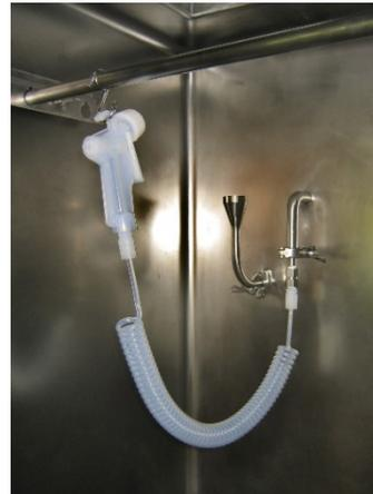
Isolatornutzraum mit Isokinetischer Sonde
