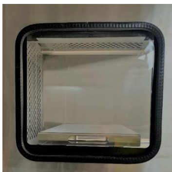
Draufsicht Transfertisch und Schiebescheibe
